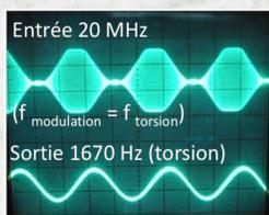
Transfert d'énergie entre bande de fréquence
